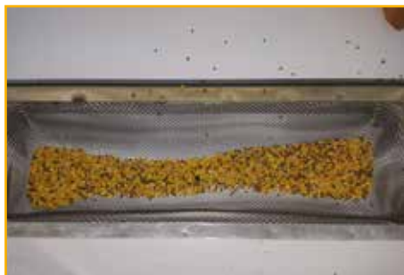
Osmukalni predalček iz nerjaveče mrežaste pločevine z vzvodom za enostavno nameščanje
